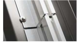
C. För ihop med nästa skena. Profilförbindarens bula skapar med fördel en liten glipa, som tillåter termisk utvidgning.
