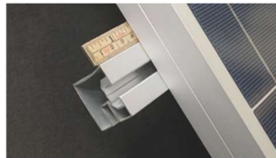
B. Skena behöver sticka ut minst 40 mm.
