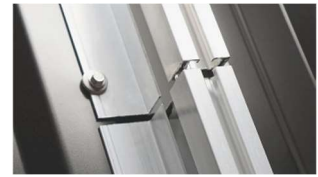
C. För ihop med nästa skena. Profilmförbindarens bula skapar med fördel en liten glipa, som tillåter termisk utvidgning.
