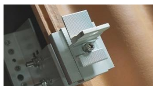
H Alternativ 1 – Stående layout. För stående layout, montera adapter enligt bild. Åtdragningsmoment 8–10 Nm
