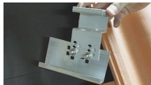
E. Efter önskad höjd, skruva ihop grundfäste och sidofäste med 2 st vagnsbult och fläsmutter. Åtdragningsmoment 8–10 Nm
