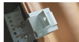
H Alternativ 2 – Liggande layout. För liggande layout, montera adapter enligt bild. Åtdragningsmoment 8–10 Nm
